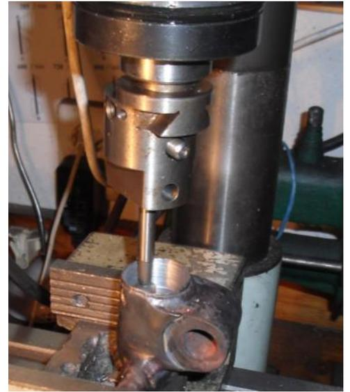
Vor dem Auftrennen des Rahmens wurde natürlich eine Aufnahmevorrichtung für den Rahmen angefertigt. Nachdem die Einzelteile soweit fertig waren, konnte der Rahmen erstmals in der Vorrichtung zusammengesteckt werden.
