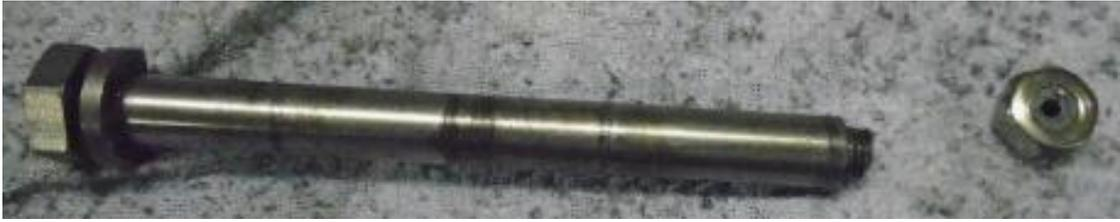
10. Am Dekompressionshebel Druckknopf vom Unterbrecherknopf verloren. Neuen Druckknopf angefertigt und mit Schraubensicherung eingeklebt.
