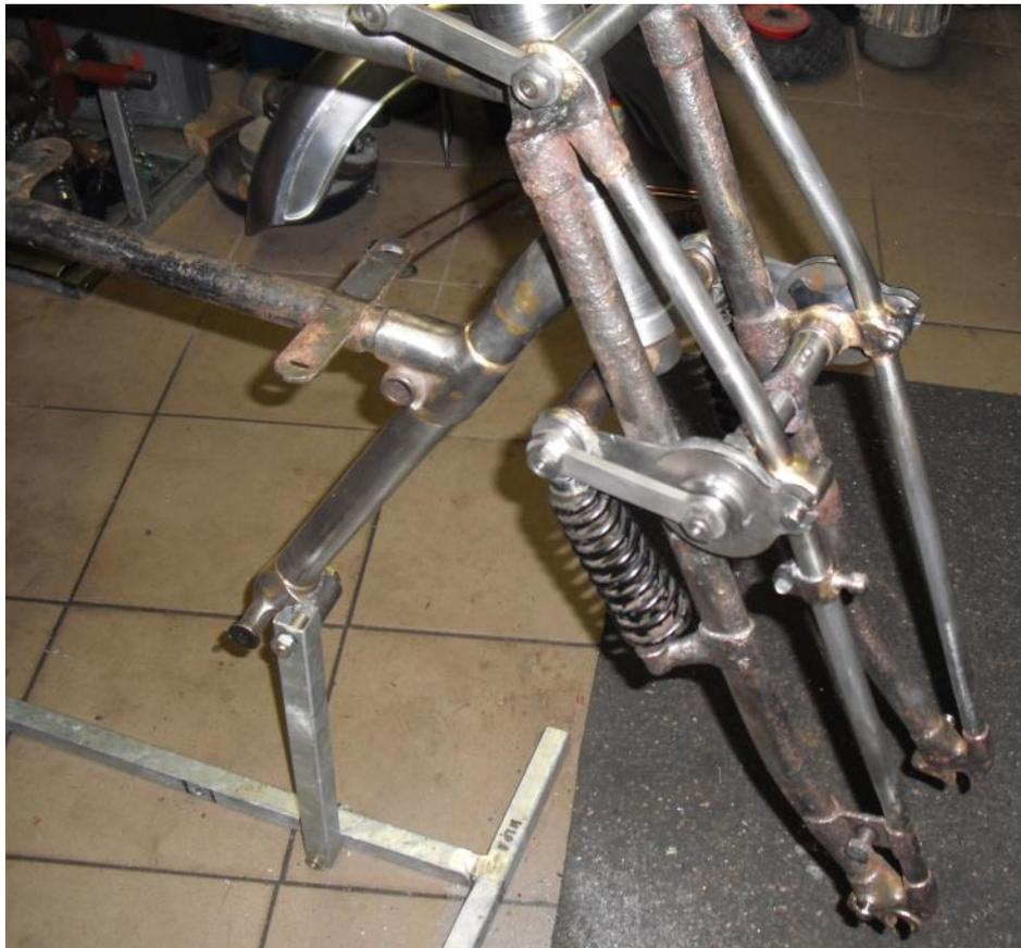
Bei der Anfertigung des Steuerkopfes wurde natürlich die Lagerung gleich auf Kegelrollenlager umgestellt.
