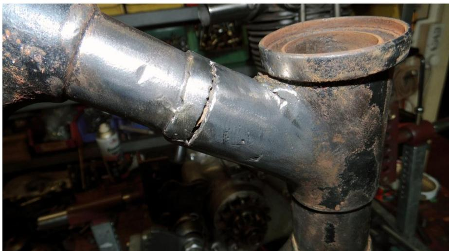
Bloß gut, dass der Steuerkopf schief stand und somit der Pfusch an das Tageslicht kam. Nicht auszudenken, dies wäre bei einer rasanten Kurvenfahrt passiert!!!
