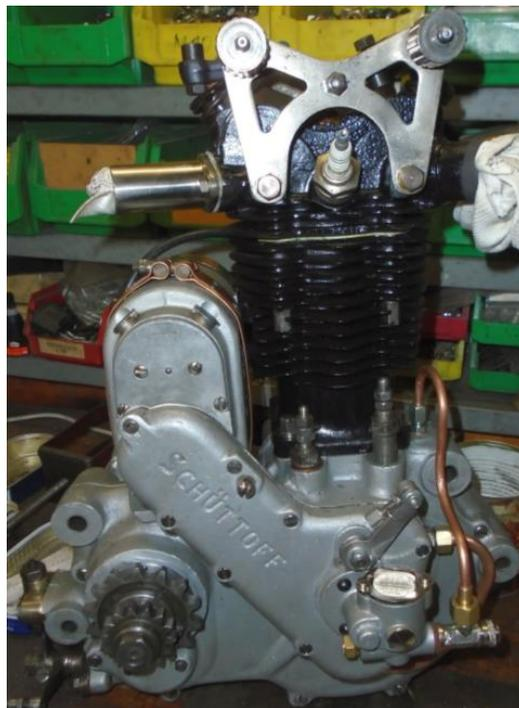
Das Anschlußrohr für den Vergaser wurde aus CrNi-Stahl gefertigt, da Edelstahl 50% der Wärmeleitfähigkeit von Stahl hat. Die Zündlichtmaschine wurde ebenfalls von einem Oldtimerliebhaber überholt.
