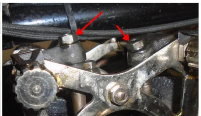
22. Der 2.Gang springt bei Belastung heraus. Feder in Schaltarretierung verstärkt. Dadurch Mangel abgestellt.
