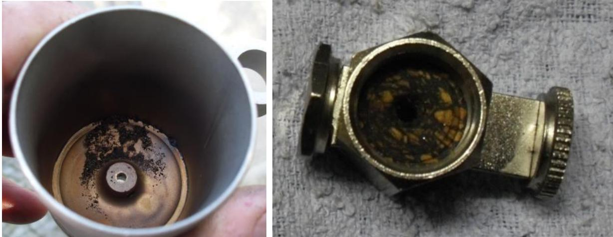
3. Kupplung kuppelt nicht richtig aus - Druckstück und Kugel in der Schnecke sind verschweißt
