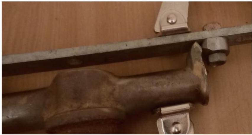
Die Querrohre in der Gabel, waren sehr stark eingelaufen und die Gewinde nicht zu gebrauchen. Am Gabelkopf des Steuerrohres waren die Aufnahmen für die Federn abgesägt worden. Als erstes musste also wieder eine Vorrichtung für die Gabel angefertigt werden. Die Querrohre und vorderen Rahmenrohre wurden ausgesägt, ausgebohrt und anschließend wieder eingelötet. Auch die Laschen für die Federaufnahmen wurden angeschweißt.
